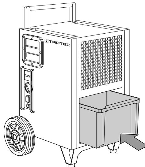
Pokud je nádoba na kondenzát plná nebo není správně vložena, rozsvítí se kontrolka LED *Nádoba na kondenzát* (16). Kompresor a ventilátor se vypne.
