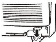
4. Zkontrolujte, že dva háčky na spodu předního krytu jsou uchyceny ve dvou otvorech ve spodu zařízení a zacvakněte kryt zpět.
