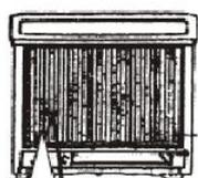
3. Vyndejte filtr z plastového obalu a vložte jej zpět do zařízení. Hlavní filtr by měl být vyměněn každých cca 12 měsíců.
