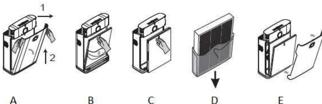
1. Uchopte přední panel na horní straně a zatlačte ukazováčky proti západkám: poté vyklopte panel směrem k sobě a vzhůru a vyjměte jej z přístroje (Obrázek A).
