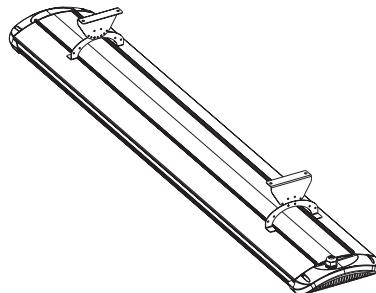
Il supporto da fissare al muro presenta una serie di fori che permettono di fissare il riscaldatore in 6 diverse posizioni.
