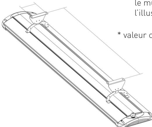
1. À l'aide d'une perceuse, réaliser quatre trous dans le mur comme indiqué dans l'illustration.
