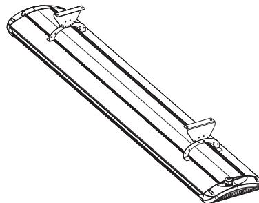
Le support à fixer au mur comporte une série de trous qui permettent de fixer le radiateur dans 6 positions différentes.
