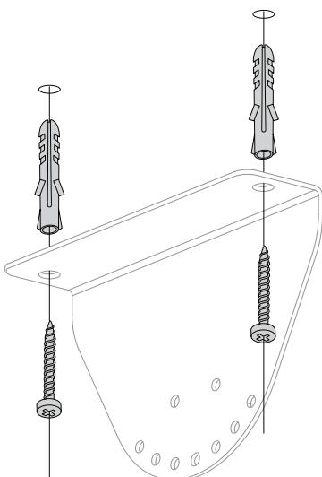
2. Fixer sur le mur les deux supports dotés de grands trous en utilisant des vis et des chevilles de dimensions appropriées.
