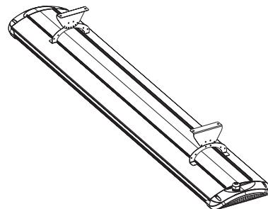
Die an der Wand oder Decke zu befestigende Halterung weist eine Reihe an Löchern auf, die eine Befestigung des Heizstrahlers in 6 verschiedenen Positionen ermöglichen.
