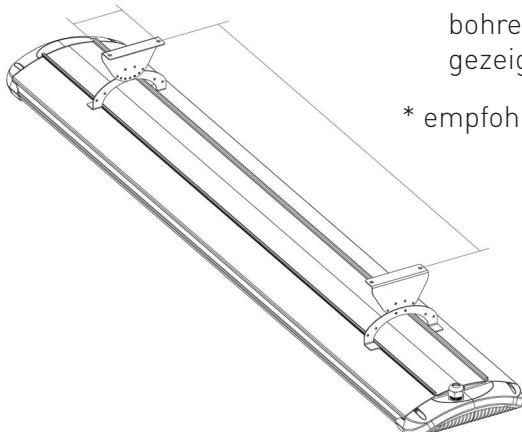
1. Mit einem Bohrer mit geeigneter Spitze vier Löcher in die Mauer bohren, wie in der Graphik gezeigt.
