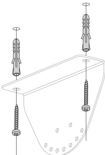
2. Fissare al muro i due supporti con fori grandi utilizzando viti e tasselli di misura appropriata.
