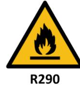
Este equipo solo está diseñado para usarse con el refrigerante R290 (propano), el cual está sellado en el circuito de refrigerante bajo presión. Las reparaciones de este equipo solo pueden ser realizadas por un profesional cualificado, en conformidad con la legislación nacional sobre sustancias inflamables. No manipule el circuito de enfriamiento, no lo pinche ni lo exponga a temperaturas más altas.
